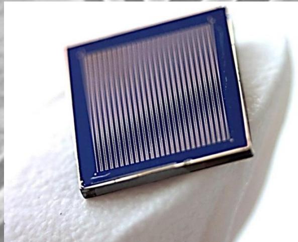
Pixel detektor za detekciju X-zraka napravljen je od kadmijevog telurija (CdTe) te je primjenjiv za medicinska snimanja i dozimetriju. 52 x 80 pixel matrica kompatibilna je sa tlocrtom koji koriste CMS eksperimenti za kapljično vezanje (Flip-Chip bonding) senzora i elektronike za očitavanje podataka - CMOS ASCI (ROC).
