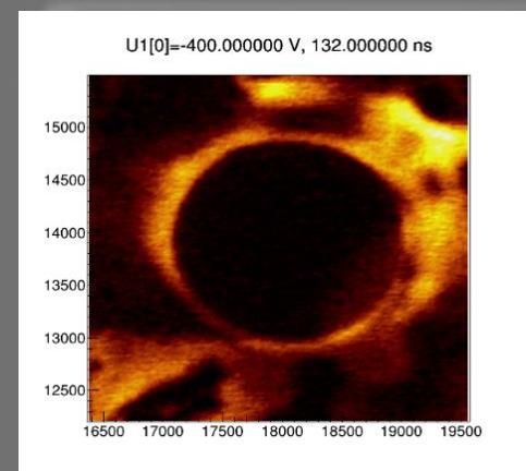
Vremenska ovisnost prikupljenog naboja izmjerena na CdTe pixel detektoru. Mjerenja izvršena skeniranjem površine detektora fokusiranim laserskim snopom.
