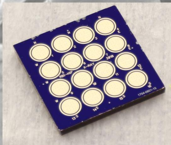
CdTe detektor X-zraka sa 16 kanala povezanih u više kanalni pretvornik koji se povezuje na mjerni uređaj. Detektori ove vrste imaju potencijal za primjenu kod sigurne nuklearne razgradnje reaktora.
