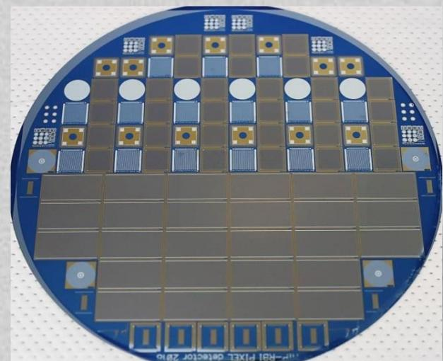
Slika silicijskog pixel detektora. Europsko vijeće za nuklearna istraživanja (CERN) koristi slične detektore za identifikaciju elementarnih čestica nastalih u sudarivačima.
